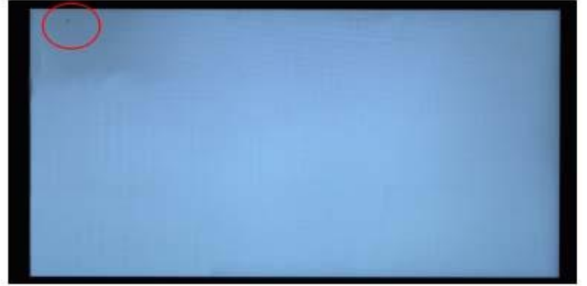
LCD屏在白屏下，机器视觉检测暗点
